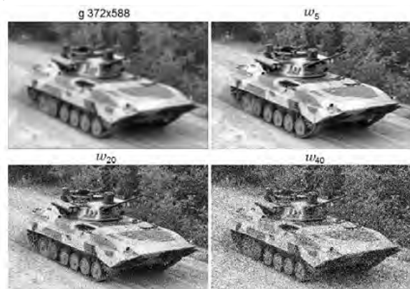
Рис. 2. Приклад обробки вихідного зображення в умовах розфокусування та змазування методом ітеративної регуляризації Фрідмана [10]
