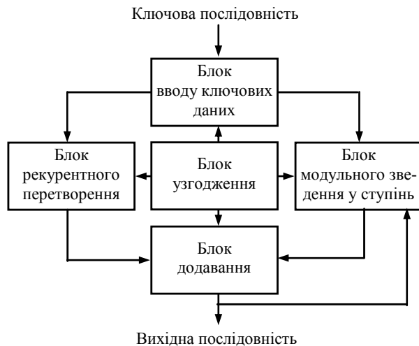
Рис. 5. Структурна схема пристрою формування псевдовипадкових послідовностей
