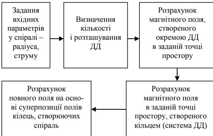
Рис. 4. Послідовність визначення магнітної індукції спіралі
