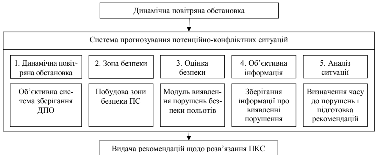
Рис. 4. Структурна схема та алгоритм функціонування системи випереджаючого моделювання МК Fusion
