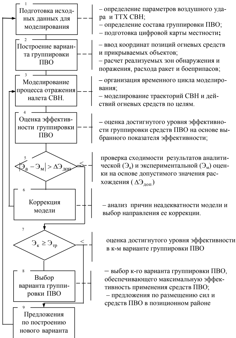
Рис. 1. Структурная схема алгоритма выбора рационального варианта построения группировки ПВО
