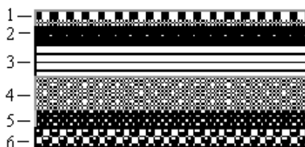
Рис. 1. Поперечний розріз фотоплівки: 1 – захисний шар; 2 – верхній емульсійний шар; 3 – нижній емульсійний шар; 4 – підшар; 5 – основа; 6 – противошар
