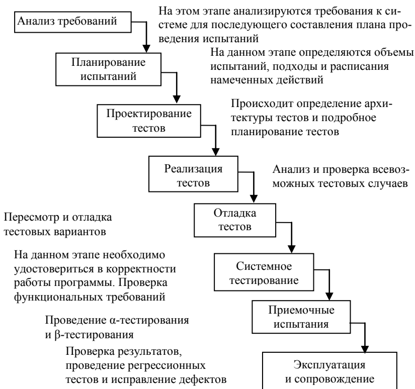
Рис. 1. Каскадная модель жизненного цикла процесса тестирования
