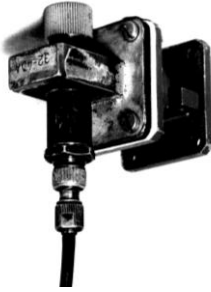
Рис. 3. СВЧ входное устройство перед РПУ
