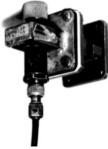
Рис. 3. СВЧ входное устройство перед РПУ
