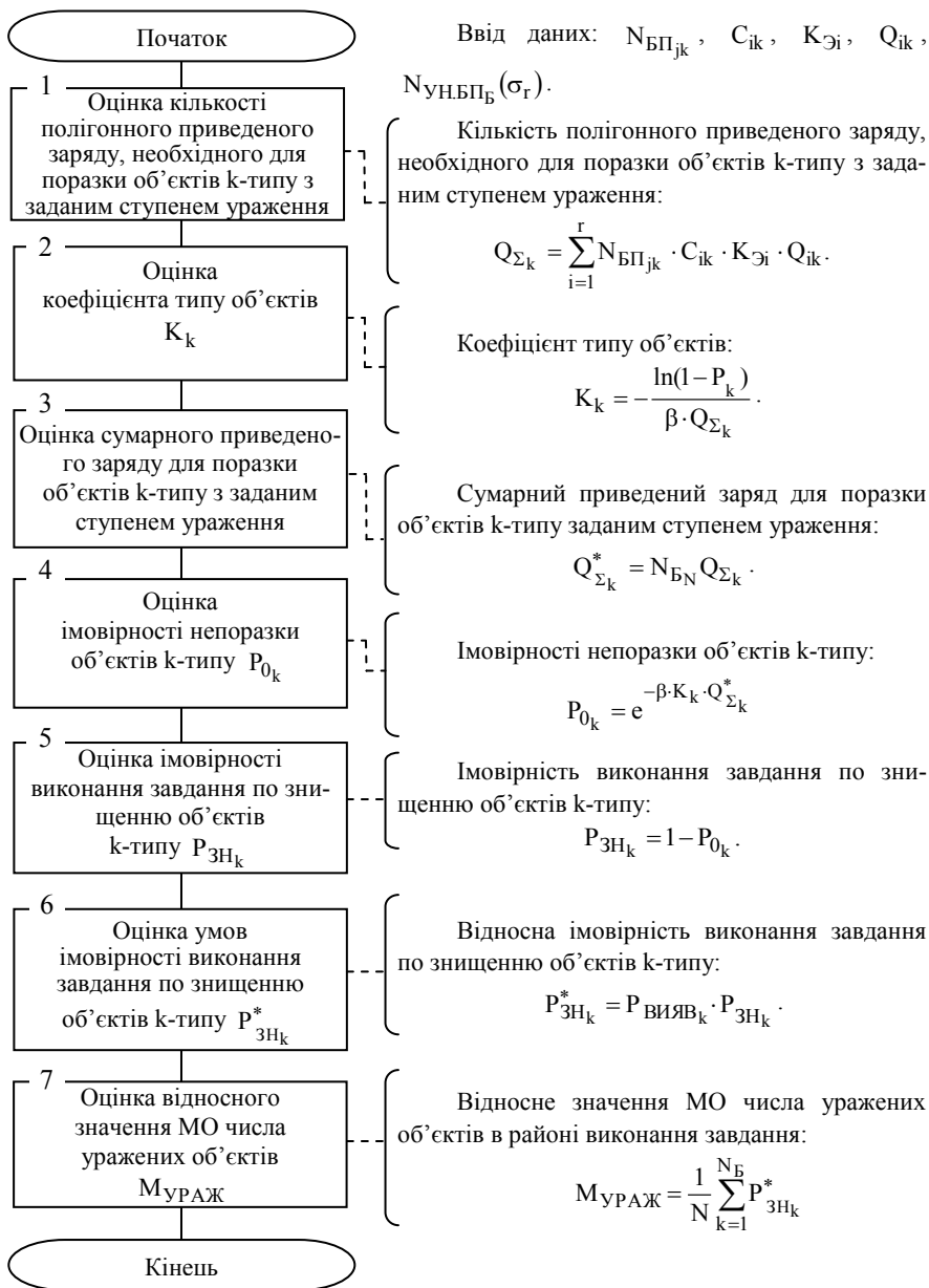
Рис. 2. Алгоритм оцінки відносного значення МО числа уражених об'єктів в районі виконання завдання з урахуванням точності визначення МПЛА бомбардувальників
