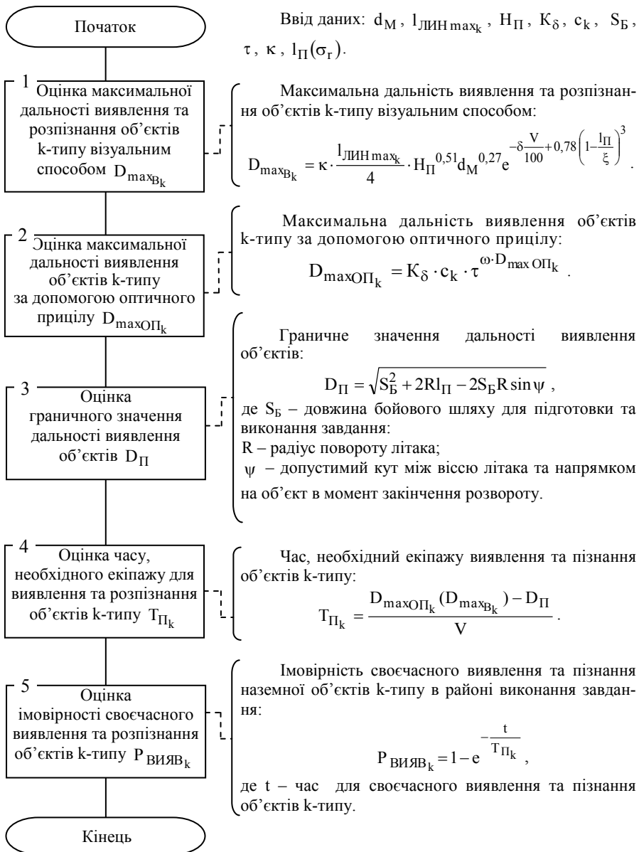
Рис. 1. Алгоритм оцінки імовірності своєчасного виявлення і впізнання об'єктів k-типу в районі виконання завдання з урахуванням точності визначення МПЛА бомбардувальників
