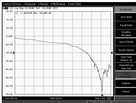
Рис. 10. Экспериментальная зависимость параметра S_{21} кабеля UTP5e, размещенного в высокопроводящем грунте, после воздействия МЭМИ
