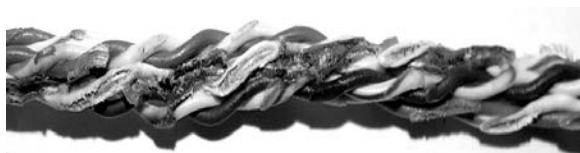
Рис. 8. Фотография общей деградации внутренних проводников кабеля UTP5e, размещенного в низкопроводящем грунте, после воздействия МЭМИ
