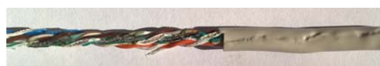
Рис. 13. Фотографии повреждения внешней изоляционной оболочки и внутренних проводников кабеля UTP5e, размещенного в высокопроводящем грунте, после воздействия МЭМИ
