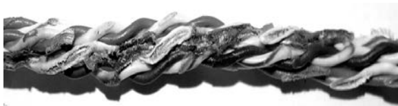
Рис. 8. Фотография общей деградации внутренних проводников кабеля UTP5e, размещенного в низкопроводящем грунте, после воздействия МЭМИ
