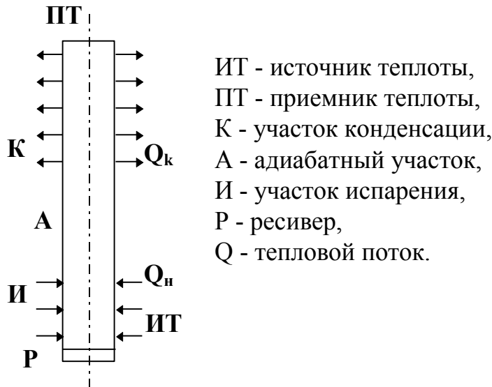
Рисунок 1 - Схема тепловой трубы
