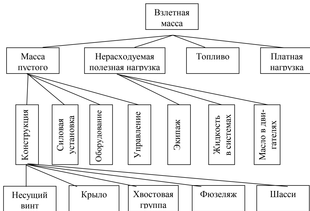
Рисунок 1 – Вариант весовой классификации, используемой фирмой Боинг - Вертол
