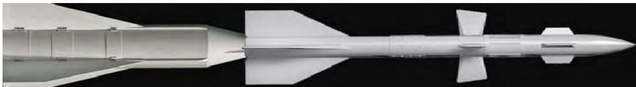
Рис. 8. ЗРК на базі ракети Р-27 (варіант)
