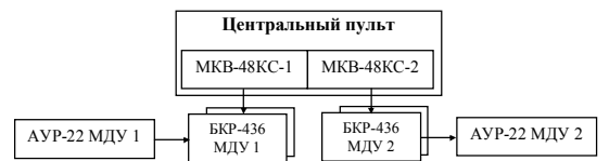
Рис. 2. Частина структурної схеми САКСУ БІКС Ан-148, що відповідає за виконання функції f_5^*
