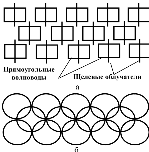
Рис. 4. Фрагмент матрицы облучателей в виде щелевых антенн – а; пример взаимного расположения ДН отдельных облучателей – б
