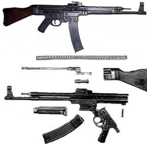
Рис. 4. Автомат штурмгевер StG-44 і його неповне розбирання
