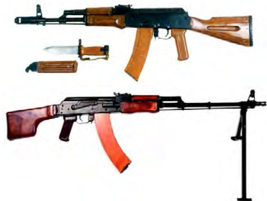
Рис. 10. 5,45-мм автомат Калашникова (АК74) та 5,45-мм ручний кулемет Калашникова (РПК74)
