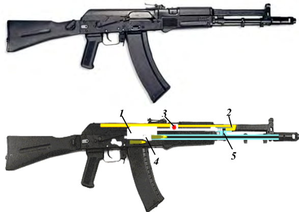
Рис. 14. 5,45-мм автомат АК107 (5,56-мм АК108) зі збалансованою системою відбою:
