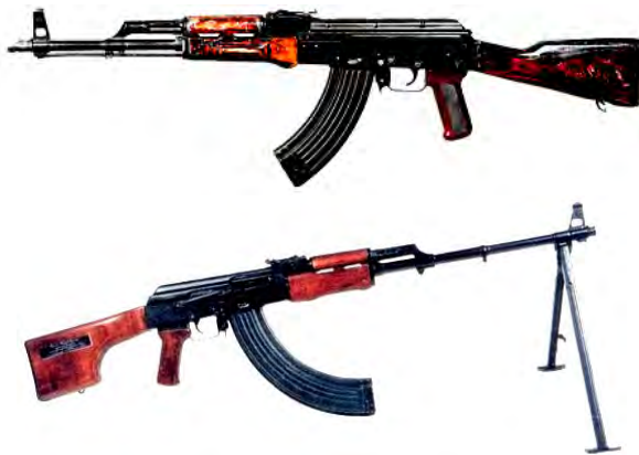
Рис. 8. 7,62-мм модернізований автомат Калашникова (АКМ) з дуловим компенсатором та 7,62-мм ручний кулемет Калашникова (РКК)
