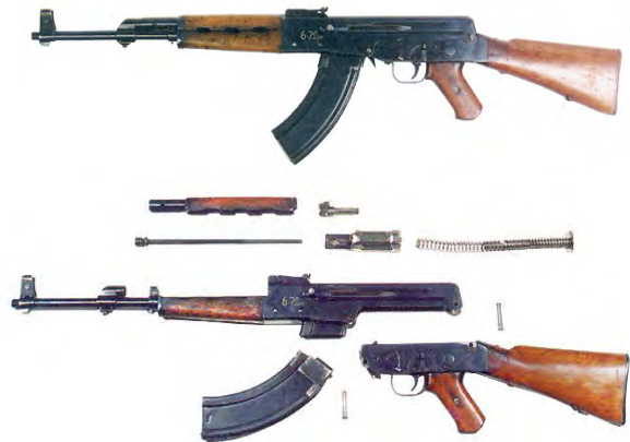
Рис. 3. Дослідницький 7,62-мм автомат АК-46 і його неповне розбирання
