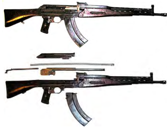
Рис. 5. Дослідницький 7,62-мм автомат Булкина (АБ-46) і його неповне розбирання
