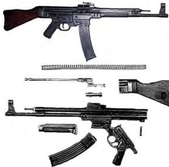
Рис. 4. Автомат штурмгевер StG-44 і його неповне розбирання
