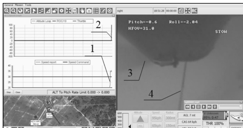
Рис. 7. Результати об'єктивного контролю моменту розгону БпЛА (етап намотування стропа): 1 – лінія змінення швидкості БпЛА; 2 – лінія змінення обертів двигуна; 3 – лопать гвинта; 4 – стропа пришвидшувача
