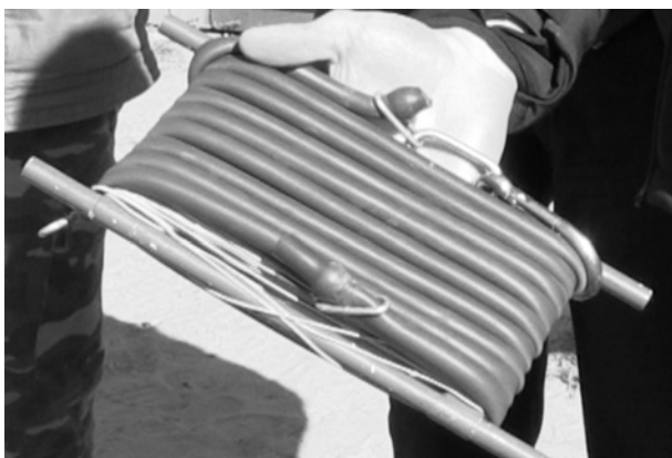
Рис. 2. Допоміжний засіб для зльоту БпЛА
