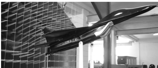
Рис. 5. Фотографія зовнішнього вигляду робочої частини АДТ Т-1 з моделлю літака-випробувача МиГ-29 без протока
