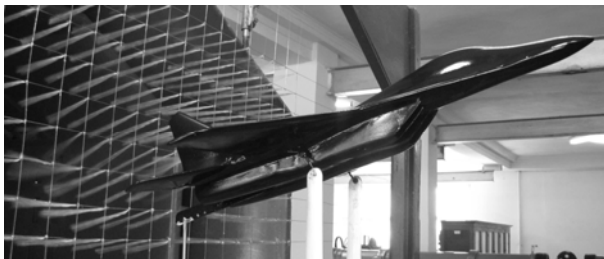
Рис. 4. Фотографія зовнішнього вигляду робочої частини АДТ Т-1 з моделлю літака-випробувача МиГ-29 з протокою
