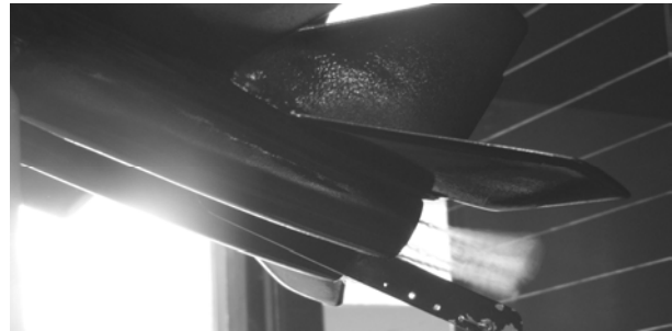
Рис. 7. Фотографія хвостової частини моделі літака-випробувача МиГ-29 без протока
