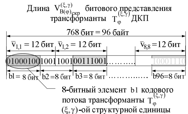
Рис. 4. Схема формирования элементов по 8 бит из битового потока компонент трансформанты T_{\phi}^{(\xi, \gamma)} ( \xi, \gamma )-й структурной единицы базового видеокadra
