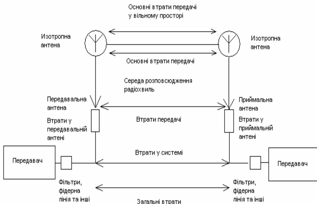
Рис. 1. Структура лінії радіозв'язку
