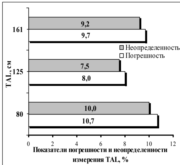
Рис. 5. Показатели погрешности и неопределенности измерений TAL в цилиндрах
