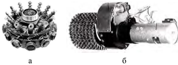
Рис. 2. Измерение давления на МЛА с помощью ЭМПК
