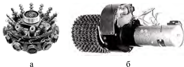
Рис. 2. Измерение давления на МЛА с помощью ЭМПК
