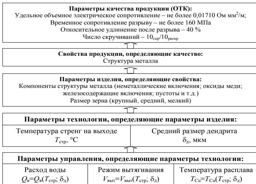
Рис. 2. Связь между параметрами технологии и параметрами качества непрерывных медных отливок
