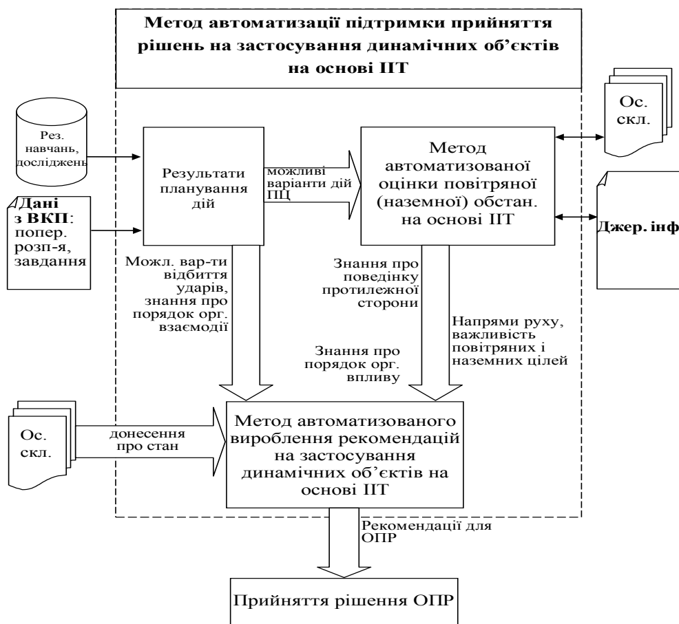
Рис. 2. Схема методу автоматизованого вироблення рекомендацій на застосування динамічних об'єктів на основі ІТ
