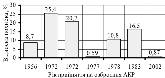
Рис. 1. Залежність величини максимальної відносної похибки при визначенні вартості АКР
