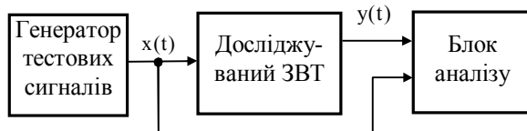
Рис. 3. Узагальнена схема для визначення динамічних характеристик МВТ
