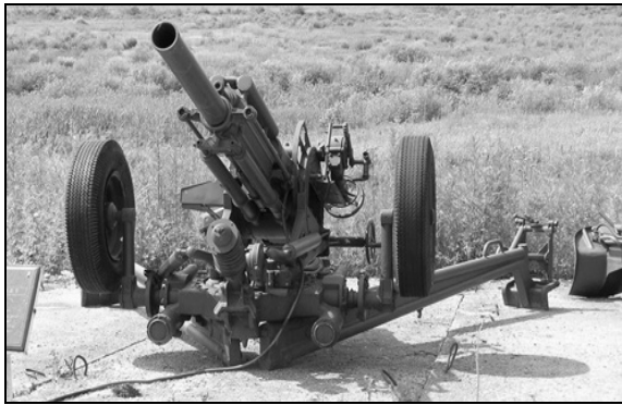
Рис. 3. 82 мм автоматичний міномет 2Б9 «Волошка»
