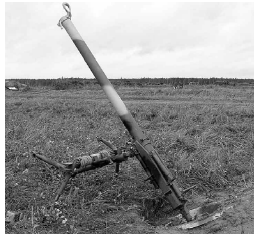
Рис. 2. 120 мм буксирований нарізний полуавтоматичний міномет 2Б23 "Нона-М1"
