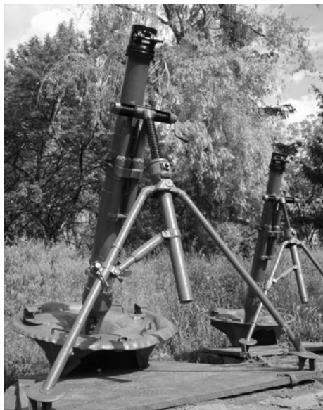
Рис. 1. 120 мм міномет 2Б11 та мінометний комплекс 2С12 «Сани»
