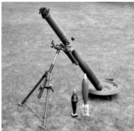
Рис. 4. 82 мм автоматичний міномет 2Б14-1 «Піднос»
