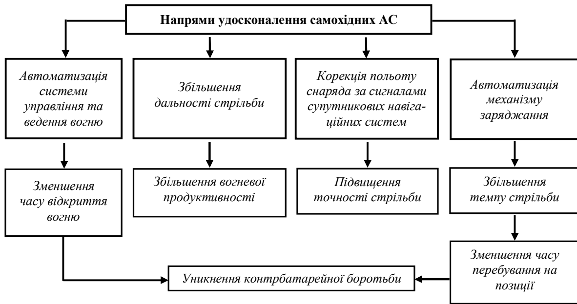
Рис. 2. Напрями удосконалення самохідних артилерійських систем
