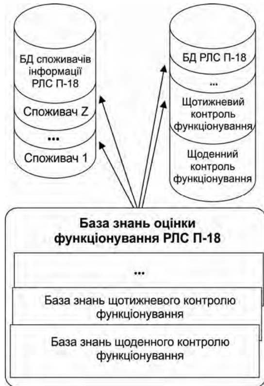
Рис. 2. Логічна структура оцінки стану РЛС П-18
