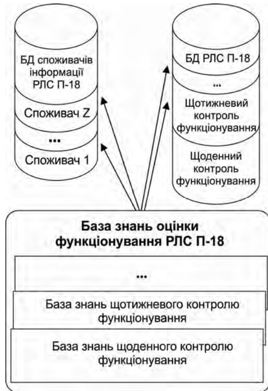
Рис. 2. Логічна структура оцінки стану РЛС П-18
