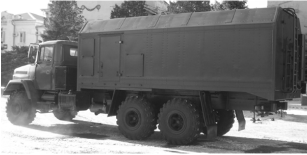
Рис. 3. Автомобільний кузов-фургон ОДАЗ-671101 на базі шасі КРАЗ 63221
