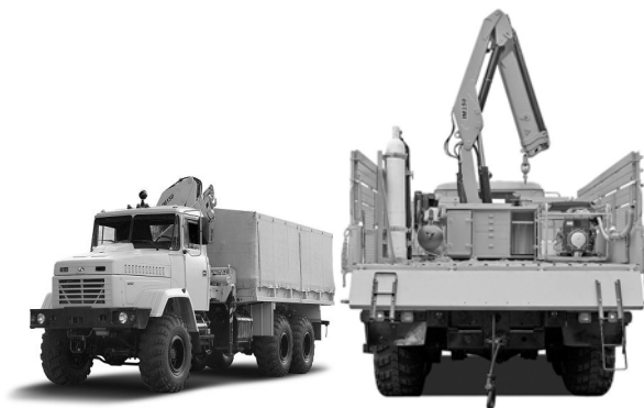
Рис. 1. Автомобіль ремонтно-евакуаційний КРАЗ-6322
