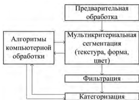
Рис. 2. Схема процесса распознавания объектов аэросъемки с применением категоризации
