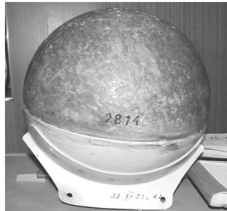
Рис. 1. Фотография линзы Льюнеберга, использованной для проведения эксперимента
