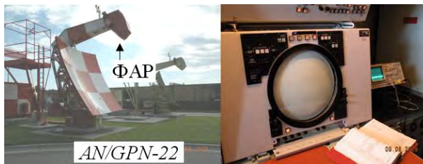
Рис. 1. Зовнішній вигляд ПРЛ AN/GPN-22 та робочого місця оператора
