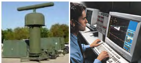
Рис. 3. Зовнішній вигляд оглядово-посадкового комплексу GCA/PAR-2000 та робочих міст операторів
