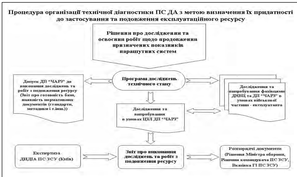
Рис. 2. Процедура організації ТД ПС ДА з метою визначення їх придатності до застосування та подовження експлуатаційного ресурсу
