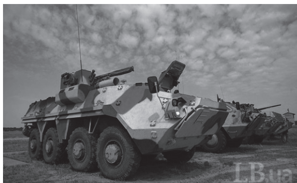
Рис. 9. БТР-4 “Буцефал” повнопривідний бронетранспортер (БТР) з колісною формулою 6х6, розроблений в Україні Харківським конструкторським бюро з машинобудування ім. Морозова (КБ ХКБМ), виготовляється на ДП ім. Малишева
