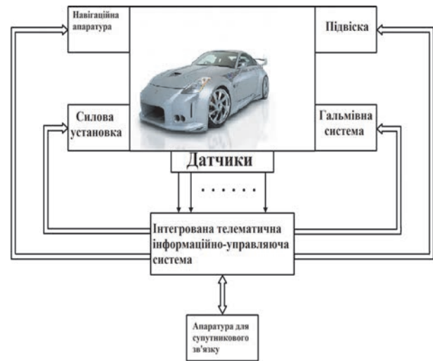
Рис. 2. Приклад інтеграції інтелектуальних мехатронних (телематичних) систем транспортного засобу
