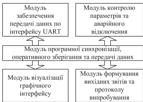
Рис. 9. Структура спеціалізованого програмного забезпечення комп'ютеризованого стенду
