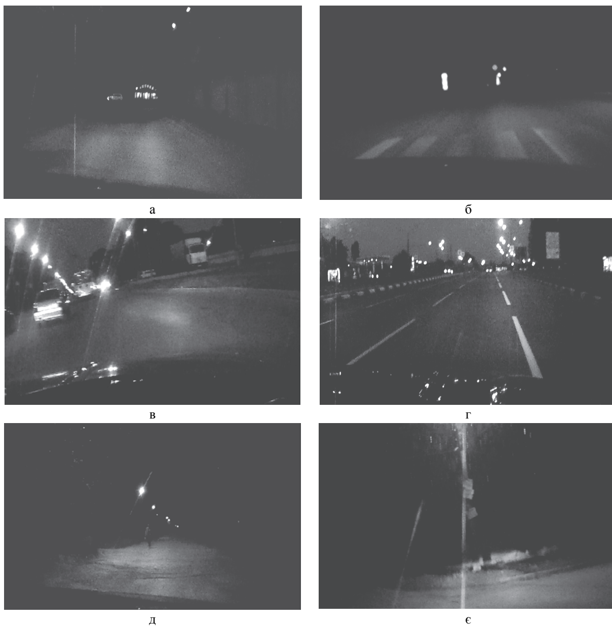
Рис. 4. Знімки з камери, встановленої в експериментальному транспортному засобі: а – освітлення провулка; б – світло автомагістралі; в – освітлення повороту; г – міське світло; д – освітлення сільської дороги з упізнанням силуету людини; е – освітлення повороту на польовій дорозі
