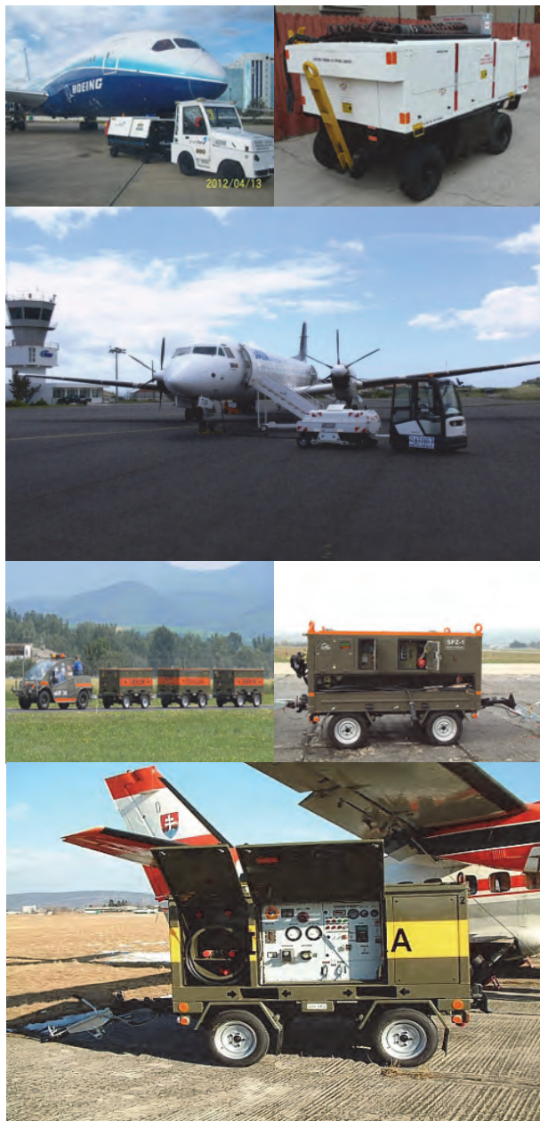
Рис. 4. Приклади багатоланкових модульних аеродромних машин
