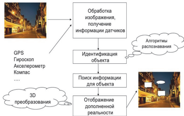
Рис. 1. Принцип роботи доповненої реальності
