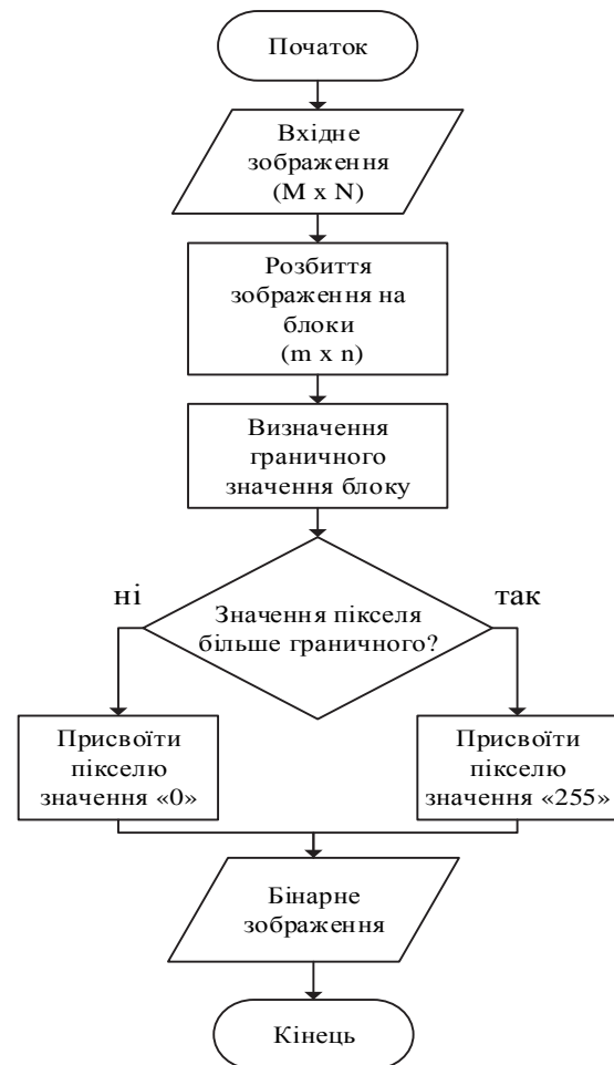
Рис. 1. Функціональна схема алгоритму бінаризації
