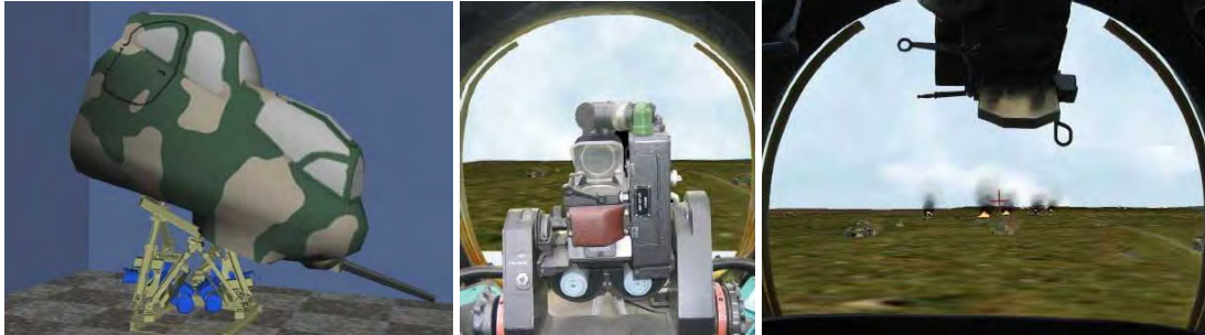
Рис. 1. Імітатор кабіни вертольоту на 6-ступеневій динамічній платформі
