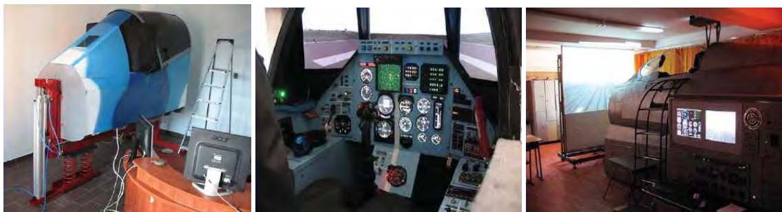
Рис. 2. Авіатренажерний комплекс нового покоління (НВО «Дискрет»)
