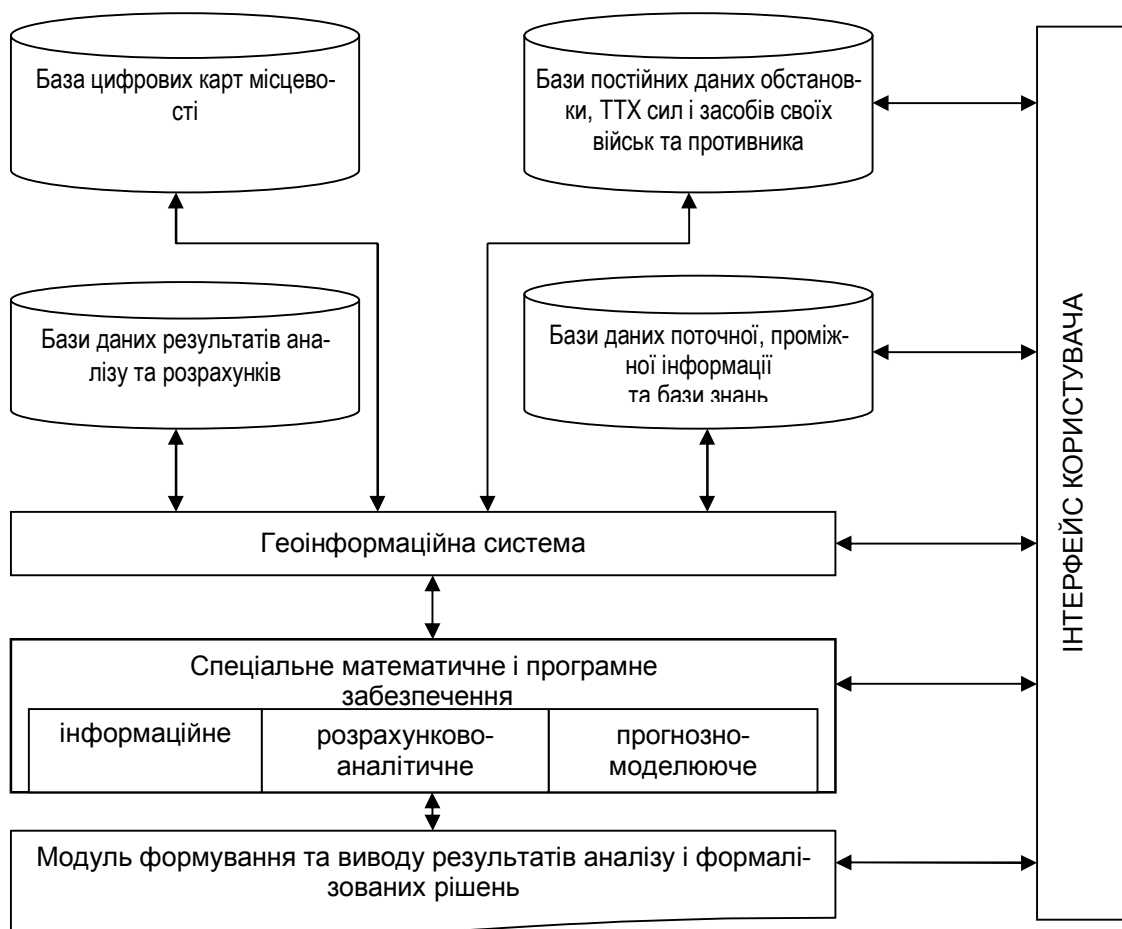
Рис. 1. Структура системи підтримки прийняття рішення
