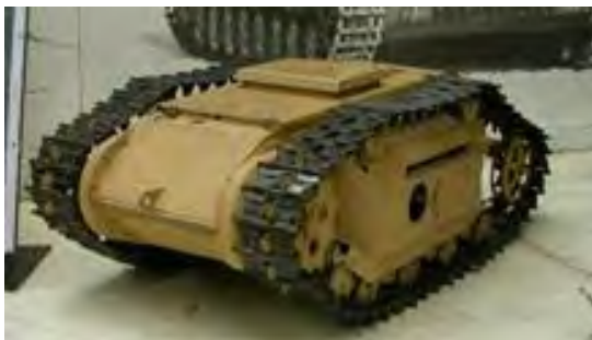
Рис. 2. Самохідна міна «Голіаф» Sd.Kfz. 303 [3]
