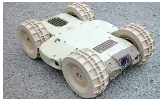
Рис. 4. Робот для тактичної розвідки Dragon Runner
