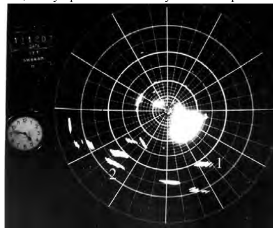
Рис. 1. Відображення первинної радіолокаційної інформації на ІКО "аналогових" РЛС
