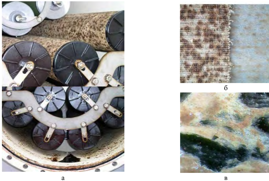
Рис. 3. Бактериальное повреждение наземных топливных фильтроматериалов [2]: а, б) – внешний вид повреждений, в – увеличенное изображение участка фильтра (10 мкм)
