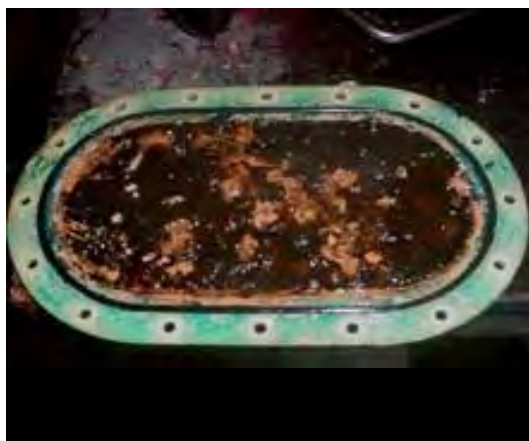
Рис. 2. Панель топливного бака с микробиологическим загрязнением [1]
