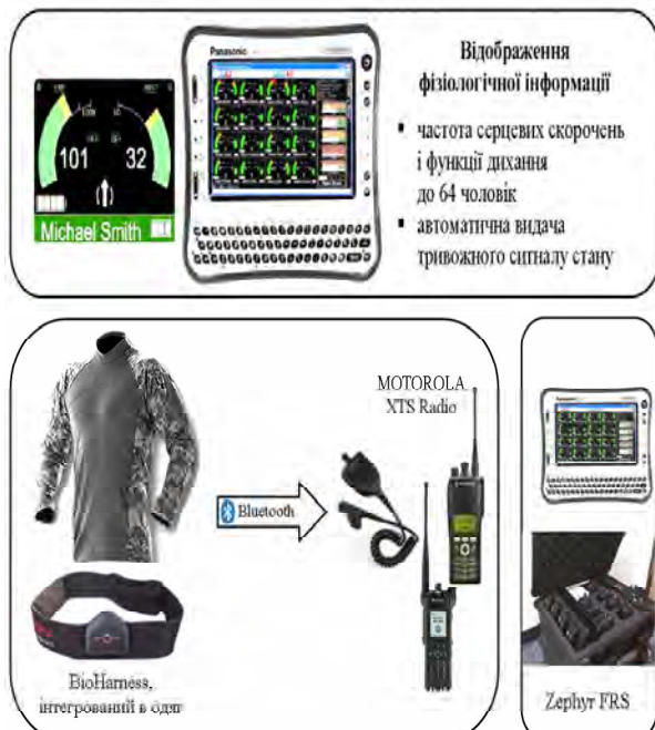
Рис. 2. Система дистанційного фізіологічного моніторингу P25 PSM
