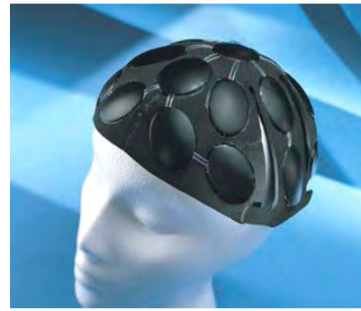
Рис. 8. Електроди Photrode, що встановлені на шоломі для безконтактної електрокардіографії
