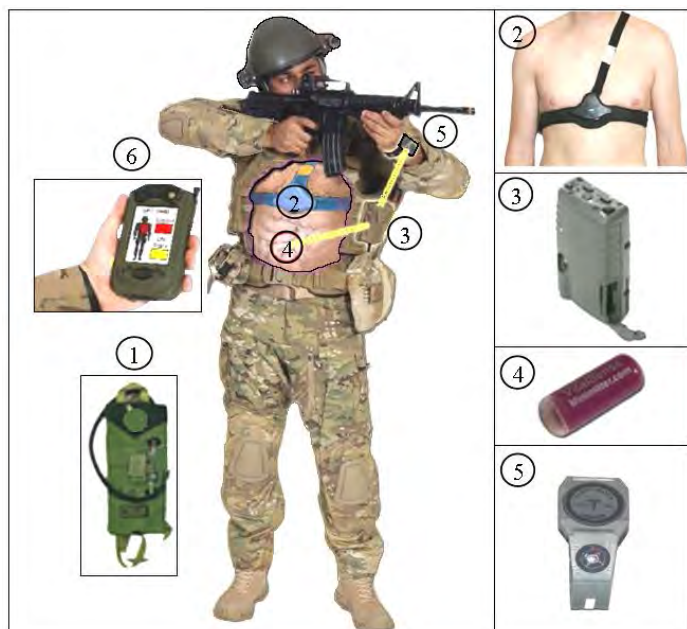
Рис. 6. Система контролю фізіологічного стану військовослужбовця WPSM (Warfighter Physiological Status Monitoring) [13]: 1 – система контролю гідратції; 2 – датчик біологічних сигналів; 3 – медичний реєстратор; 4 – внутрішній (заковтуваний) датчик температури; 5 – годинник; 6 – пульт контролю фізіологічних параметрів
