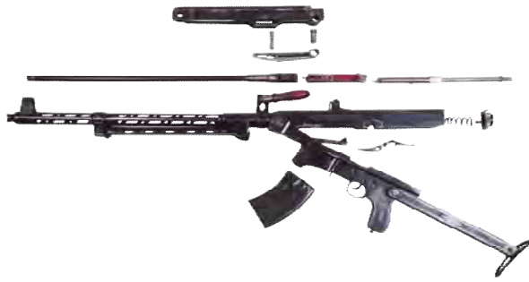
Рис. 4. Неповне розбирання 7,62-мм ручного кулемета Калашникова зр. 43 р.
