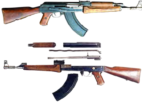
Рис. 11. КБП-580 – дослідницький 7,62-мм автомат Калашникова (АК-47) і його неповне розбирання
