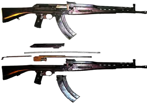
Рис. 12. ТКБ-415 – дослідницький 7,62-мм автомат Булкіна (АБ-46) і його неповне розбирання
