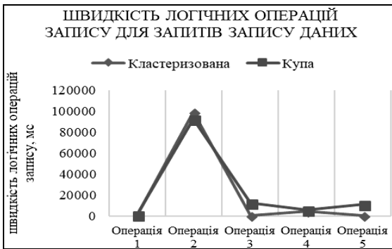
Рис. 3. Залежність швидкості логічних операцій запису для запитів запису даних від типу операції, що виконується
