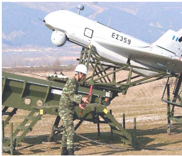
Рис. 2. Пускова установка з БпЛА Sperwer A
